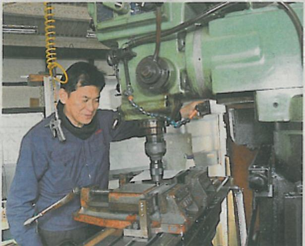
受注する自動機械の部品は自社で加工する
